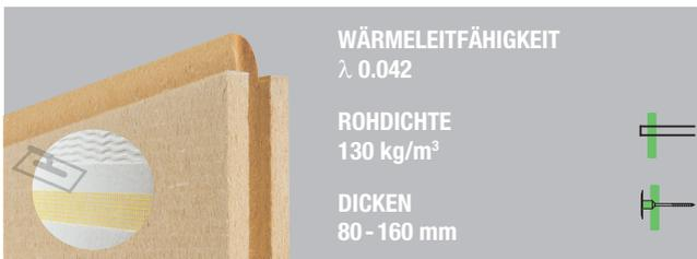
Holzfaser-Dämmplatte auch für die Vorfertigung im Holzbau mit WDVZ-Zulassung für Holzständer- und Holzmassivbau und mineralische Untergründe.
